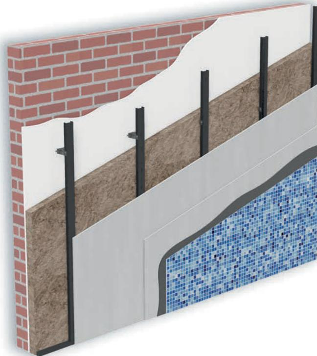
Zidne obloge sa CD 60/27/06 C3 potkonstrukcijom za direktno pričvršćenje direktnim držaćima C3. Podaci za poboljšanje zvučne izolacije pomoći.
